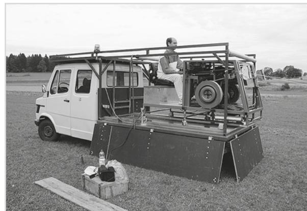
Doppeltrommelwinde auf Lkw
