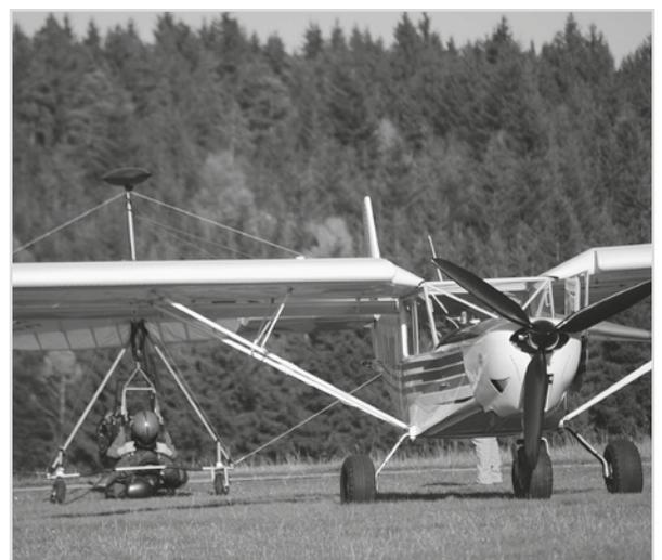
Hängegleiterschlepp mit dem Ultraleichtflugzeug
